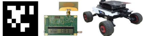
그림 1. 기준 마커 AprilTag 와 Decawave 사의 TRKE1000, WB002 안테나, 모바일 로봇
